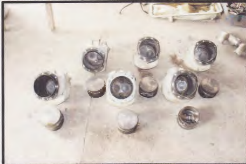
FOTOGRAFIA No. 20 MOTOR DE LA AERONAVE DESARMADO, CILINDROS Y PISTONES SIN DAÑO INTERNO
