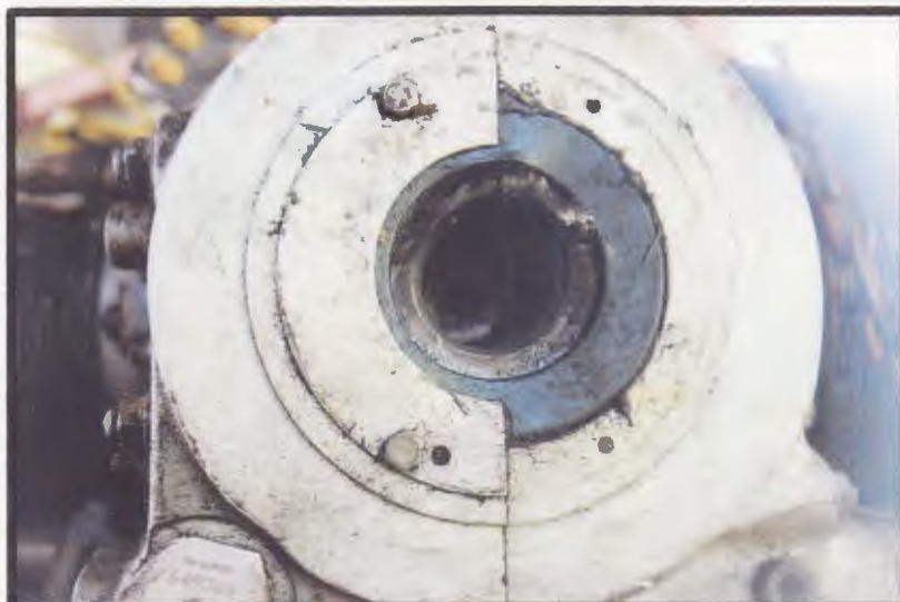
FOTOGRAFIA No. 13 VISTA FRONTAL DEL MOTOR MUESTRA EL CIGÜEÑAL ROTO
