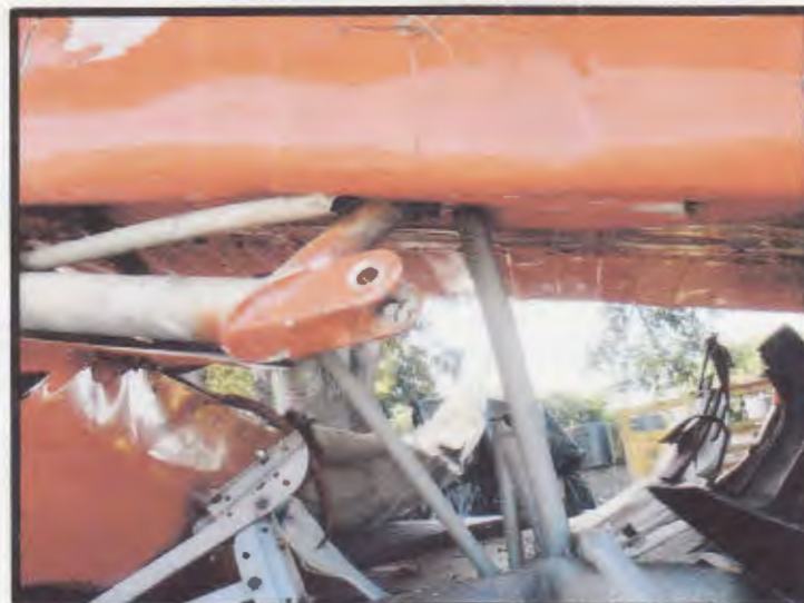
FOTOGRAFIA No. 8 DAÑOS EN LA PARTE INFERIOR DE LA AERONAVE.
