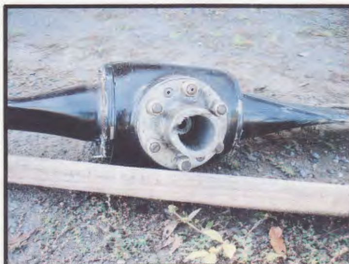
FOTOGRAFIA No. 14 VISTA DE LA HÉLICE CON SOPORTE EN EL CIGÜEÑAL ROTO
